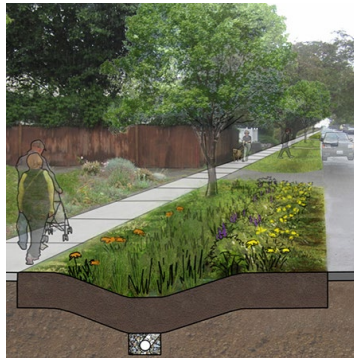
Bioswales & Rain Gardens
